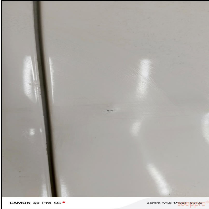
Sol arka kapıda göçük var ve rötuş boya yapılmış
