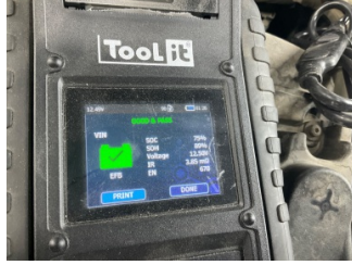
Elektrik donanımı/Pano, Akü > Test Sonucu
