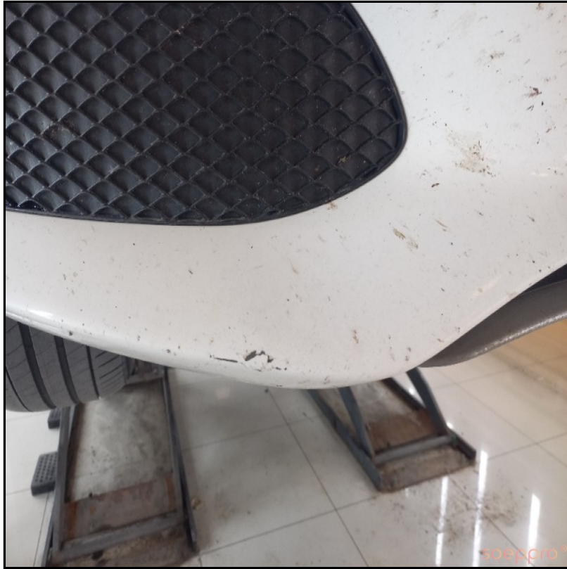
On tamponda surtme izleri mevcut
