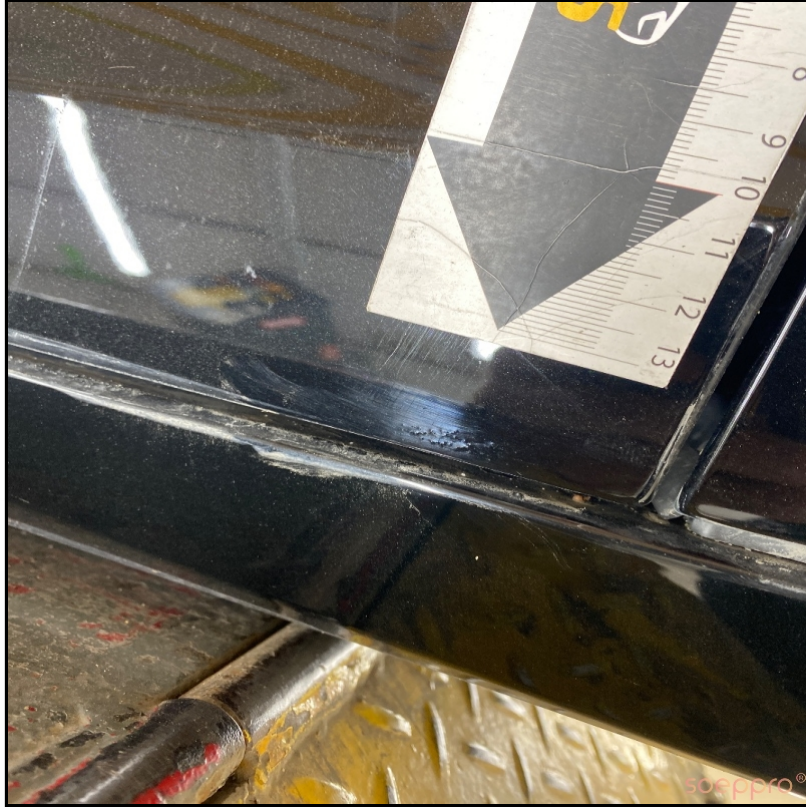
Sağ ön kapıda boya hatası mevcut
