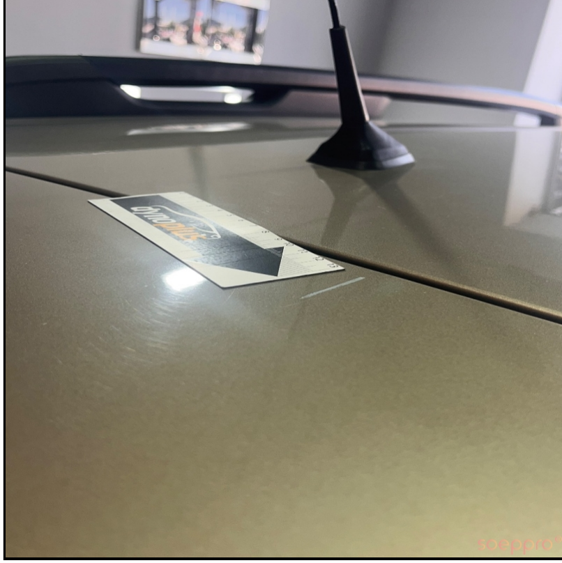
Bagaj kapağı üst kısmında derin çizik var
