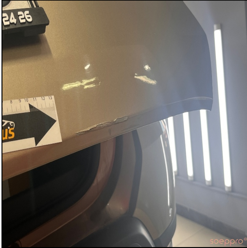
Bagaj kapağında kuru onarım ve boya da deforme var
