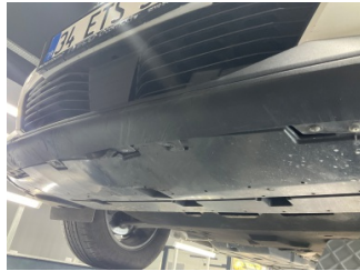
Tampon, ön, Tampon koruyucu orta > Hasarlı
