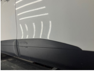
Kapı, sol arka, Kapı bandı > Çizik
