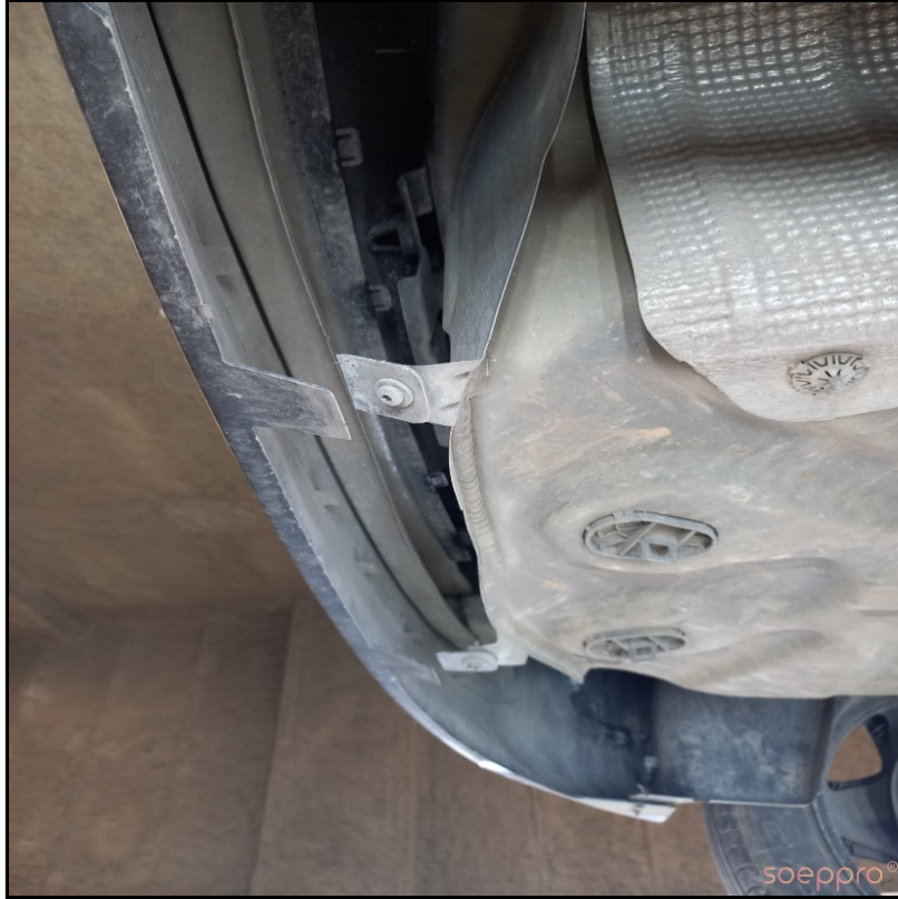
Arka Tampon alt bağlantıları kırık
