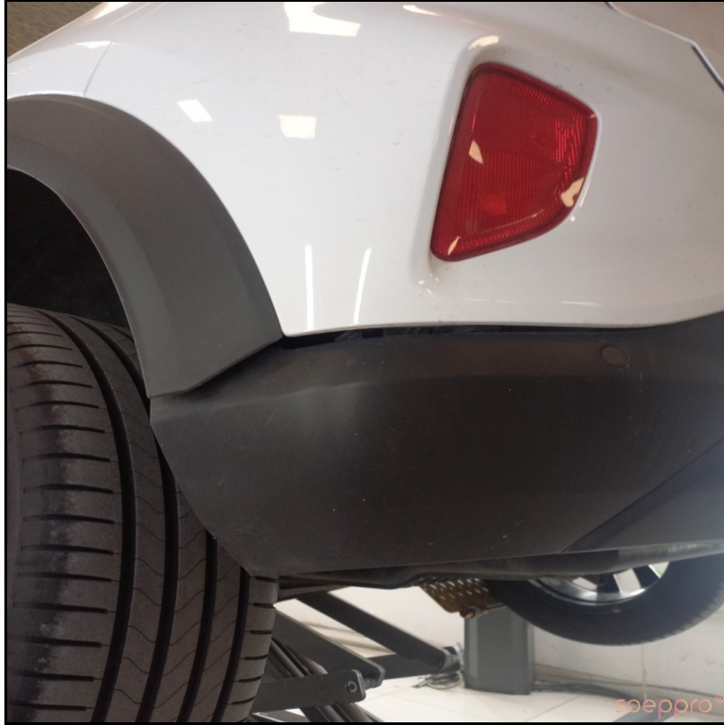
Arka tampon hasarlı
