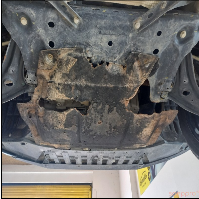
Alt muhafaza hasarlı
