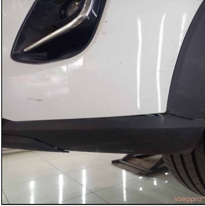
Ön tampon hasarlı
