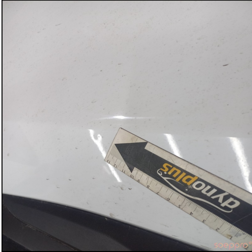
Sağ arka kapıda ezik mevcut
