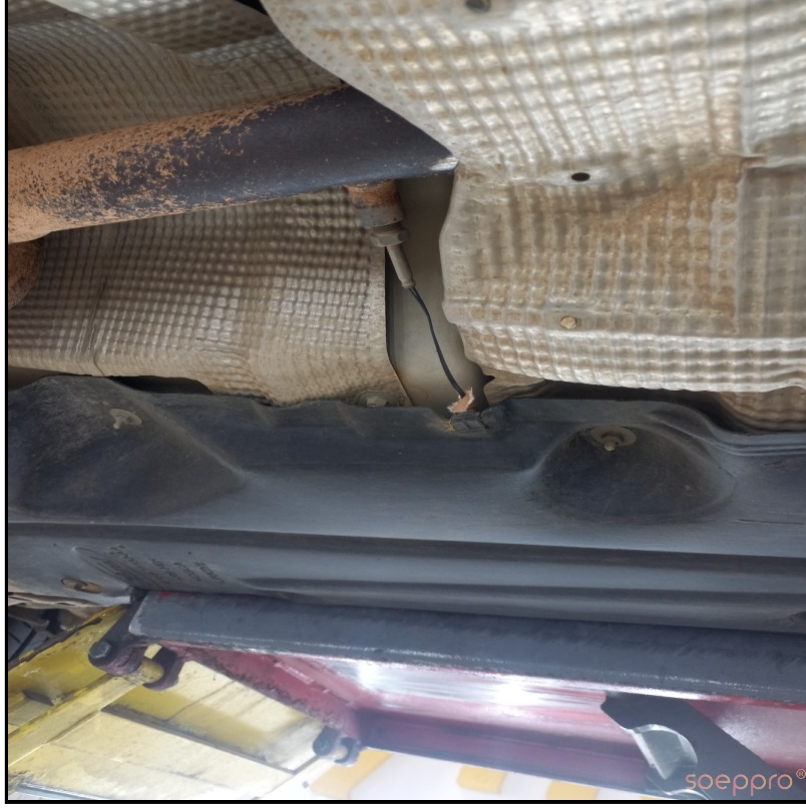
Isı kalkanı izolasyonu hasarlı
