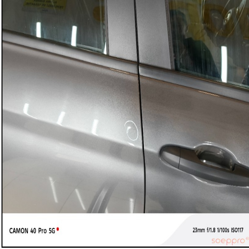
Sağ arka kapıda göçük mevcut
