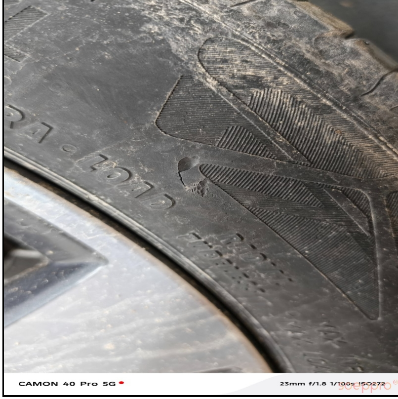
Sağ ön lastik hasarlı
