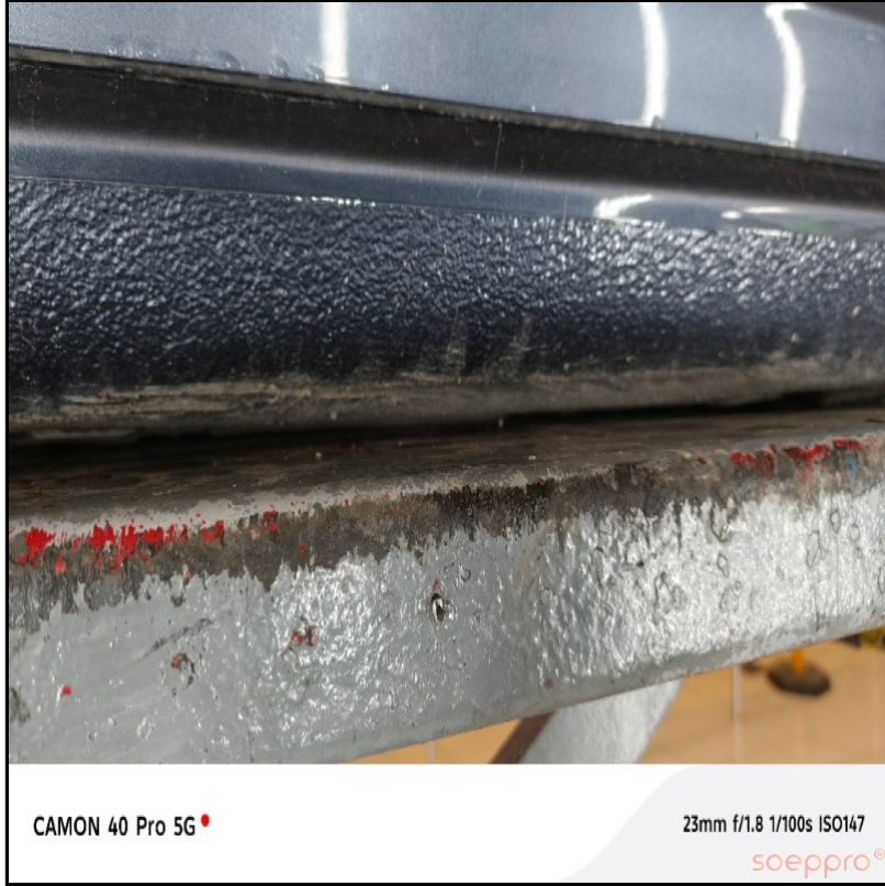
Sağ marşpiyel hasarlı
