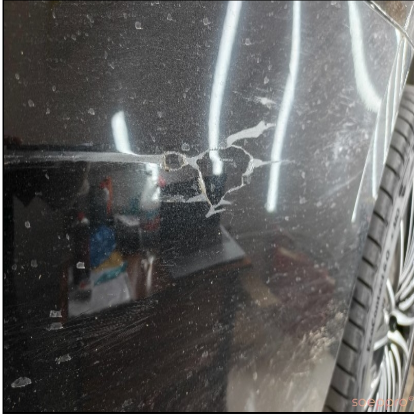
Arka tamponun kaplamasında deforme var
