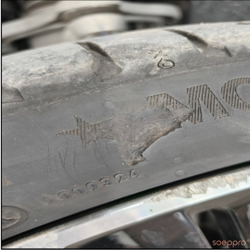
Sağ ön lastik hasarlı
