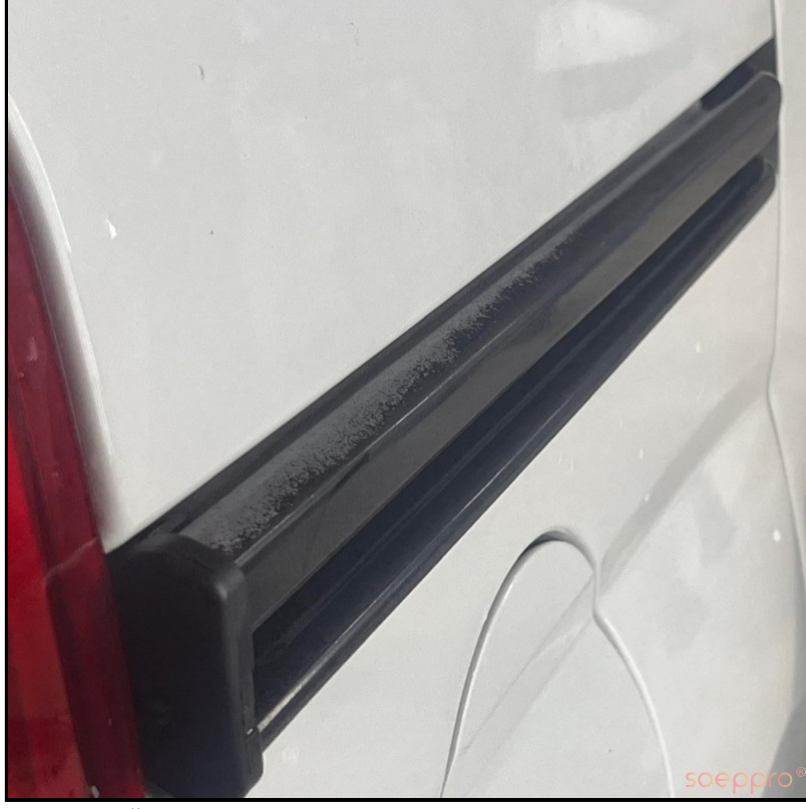
SAĞ ARKA KAPI SÜRGÜSÜ BOYASINDA DEFORME VAR
