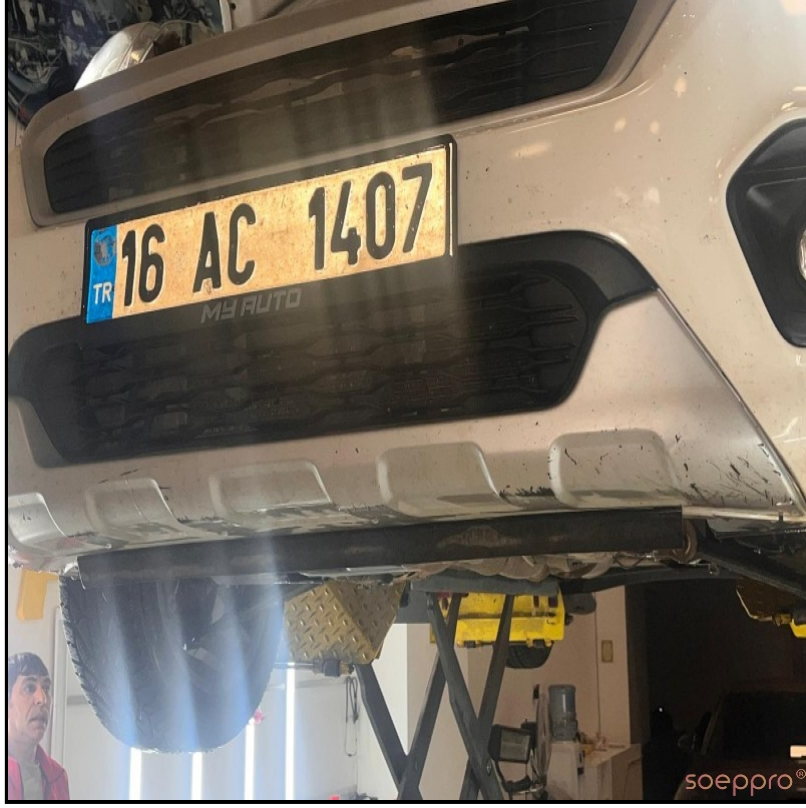
ÖN TAMPONDA DEFORMELER VAR
