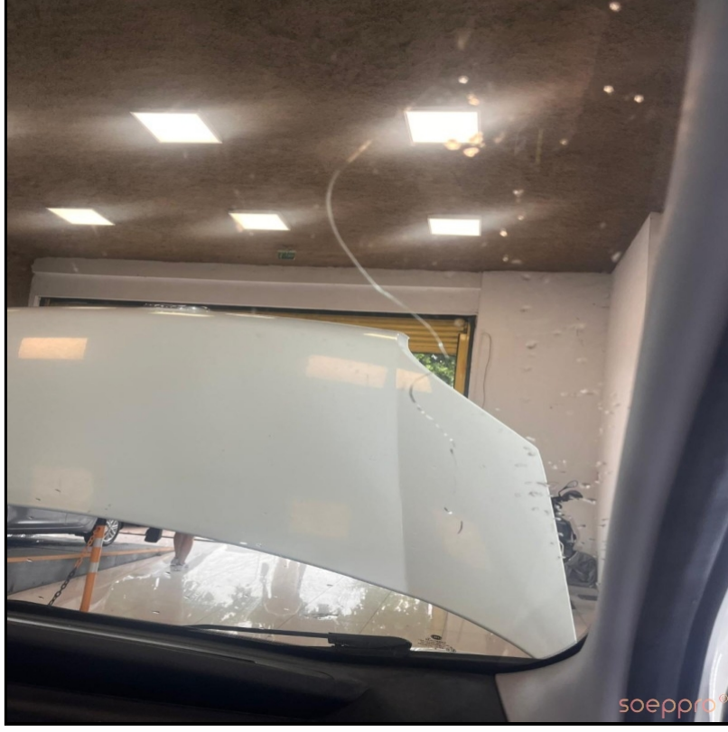
ÖN CAM ÇATLAK
