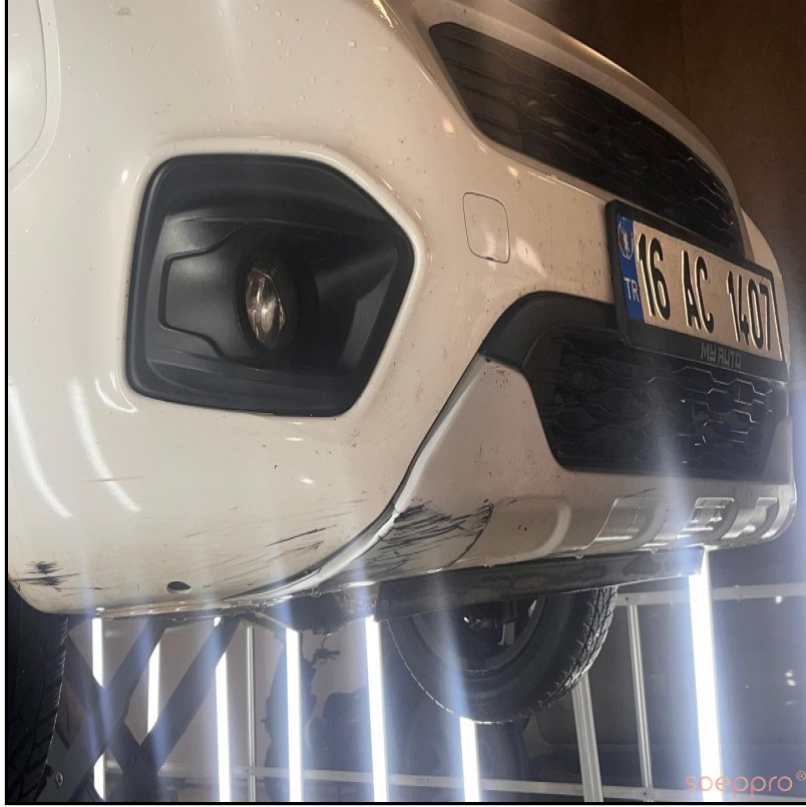
ÖN TAMPONDA DEFORME VAR
